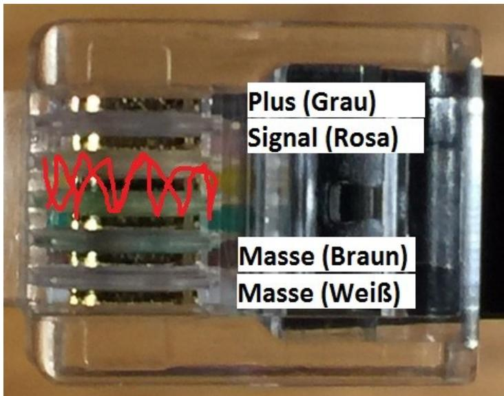
**Hinweis:** Masse ist effektiv an beiden Pins des RJ12 Steckers zu löten. D.h. also ab Poti das Kabel der Masse an beide Pins am Stecker anlöten
